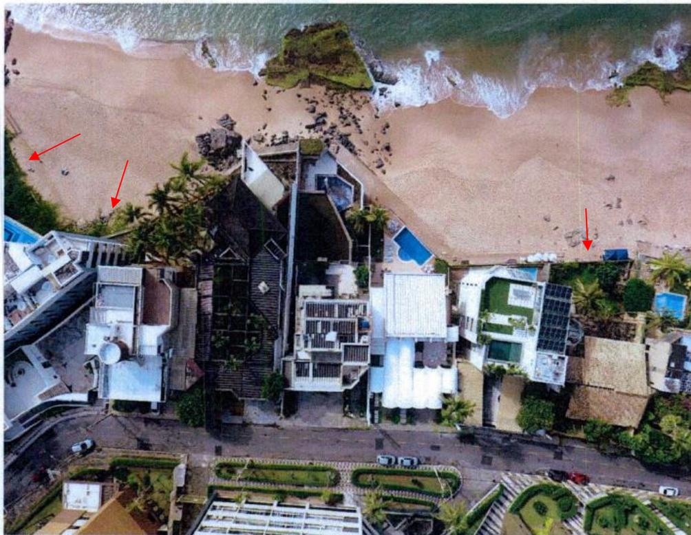
**Figura 3 – Evidência do limite da ação das ondas pela vegetação e por mureta de contenção nesta porção do Buracão (setas vermelhas) com nítida ocupação de construções sobre a praia.**
